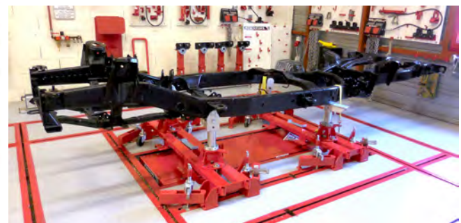
Kotvení vozidel s rámovou konstrukcí
