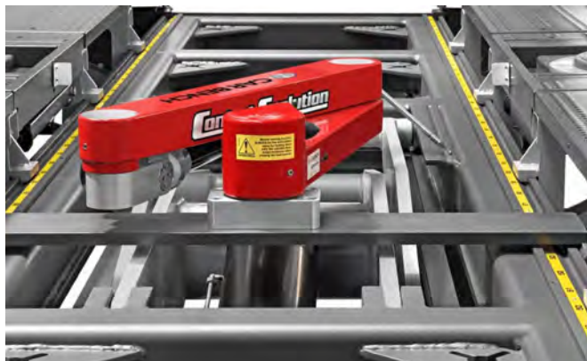
Integrace 3D měřicího systému CONTACT EVOLUTION na rovnací rám
