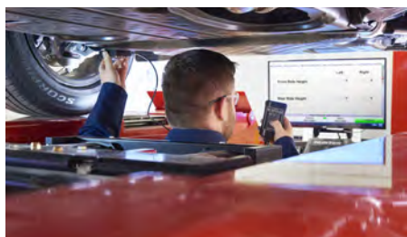
Kalkulace předepsaných hodnot podle světlé výšky nebo volitelného sklonoměru
