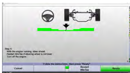
WinToe® – zajistí přímou polohu volantu bez použití blokovacího přípravku a bez opakovaného seřizování
