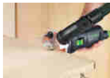
Lícovací frézování náklížků z plastu nebo z masivního dřeva.
