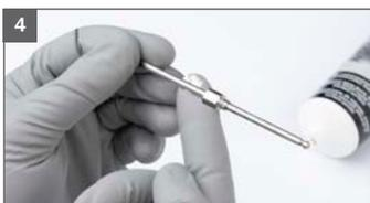
4 Farbnadel im Bereich der Nadeldichtung einfetten
