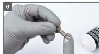
6 Farbnadelfeder einfetten und einsetzen
