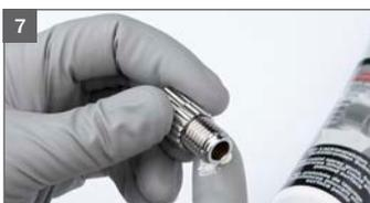
7 Gewinde der Materialmengenregulierschraube einfetten
