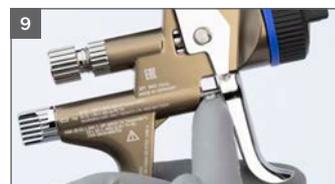
9 Sichtbarer Bereich der Luftkolbenstange einfetten
